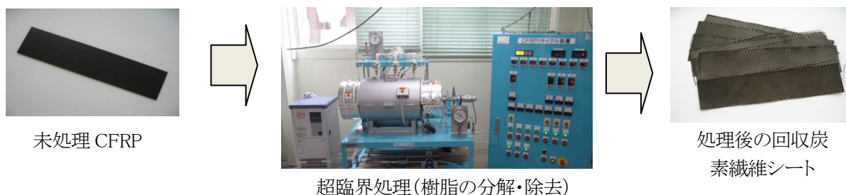
図1 超臨界流体による CFRP からの炭素繊維回収
