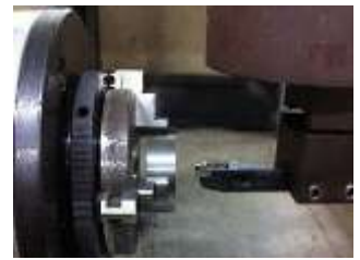
超合金のダイヤモンド切削の様子
