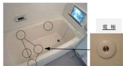
図4（浴槽内心電図・呼吸計測システム。入浴者の水没事故はもちろんのこと、生体情報を用いて日々の健康チェックや病気の予兆解析も可能に）
