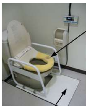
図3（トイレにおける無意識生体計測システム。体重、排泄量、排尿速度、血圧等を全自動で計測することができる）
