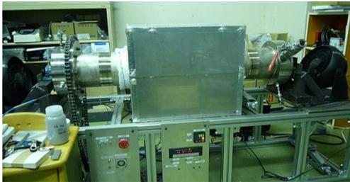
図1 ガス窒化装置
